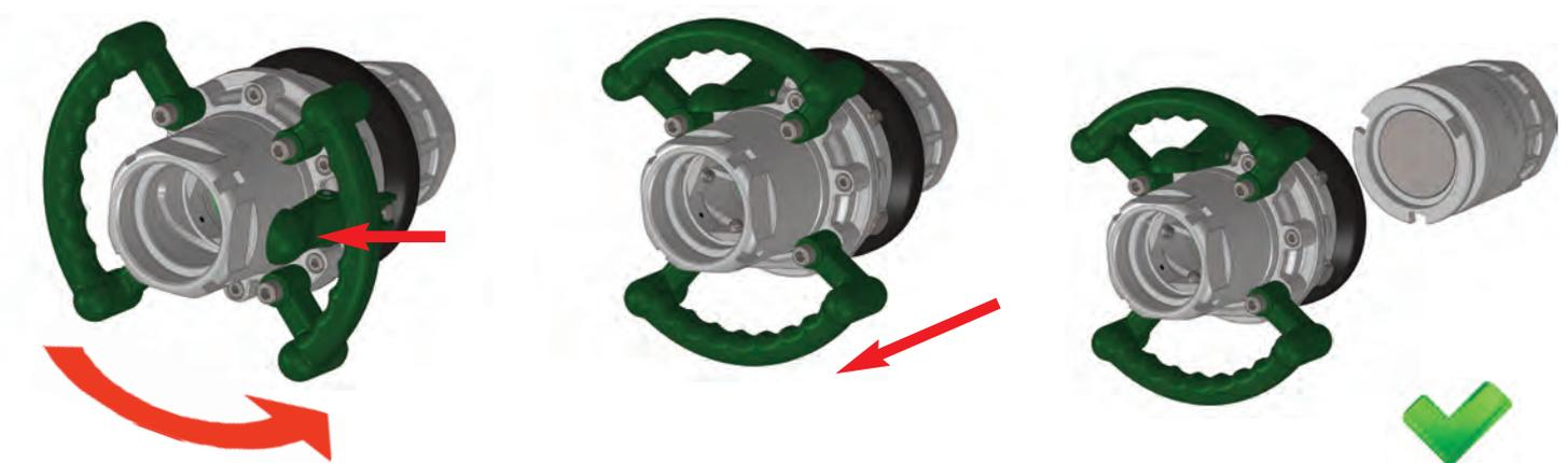
1. Bei Mutterkupplungen mit einer Arretierungsfunktion muss diese jetzt durch Drücken des Rasthebels gelöst werden.
